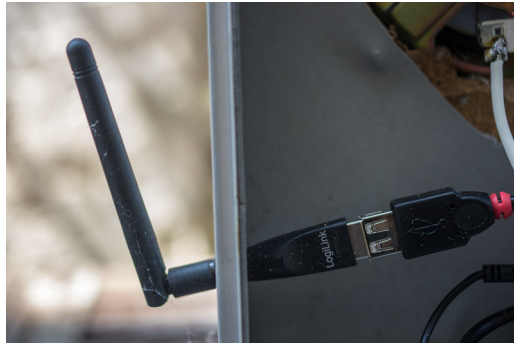
FIGURE 7.9 – Le dongle Wifi avec antenne extérieure.
