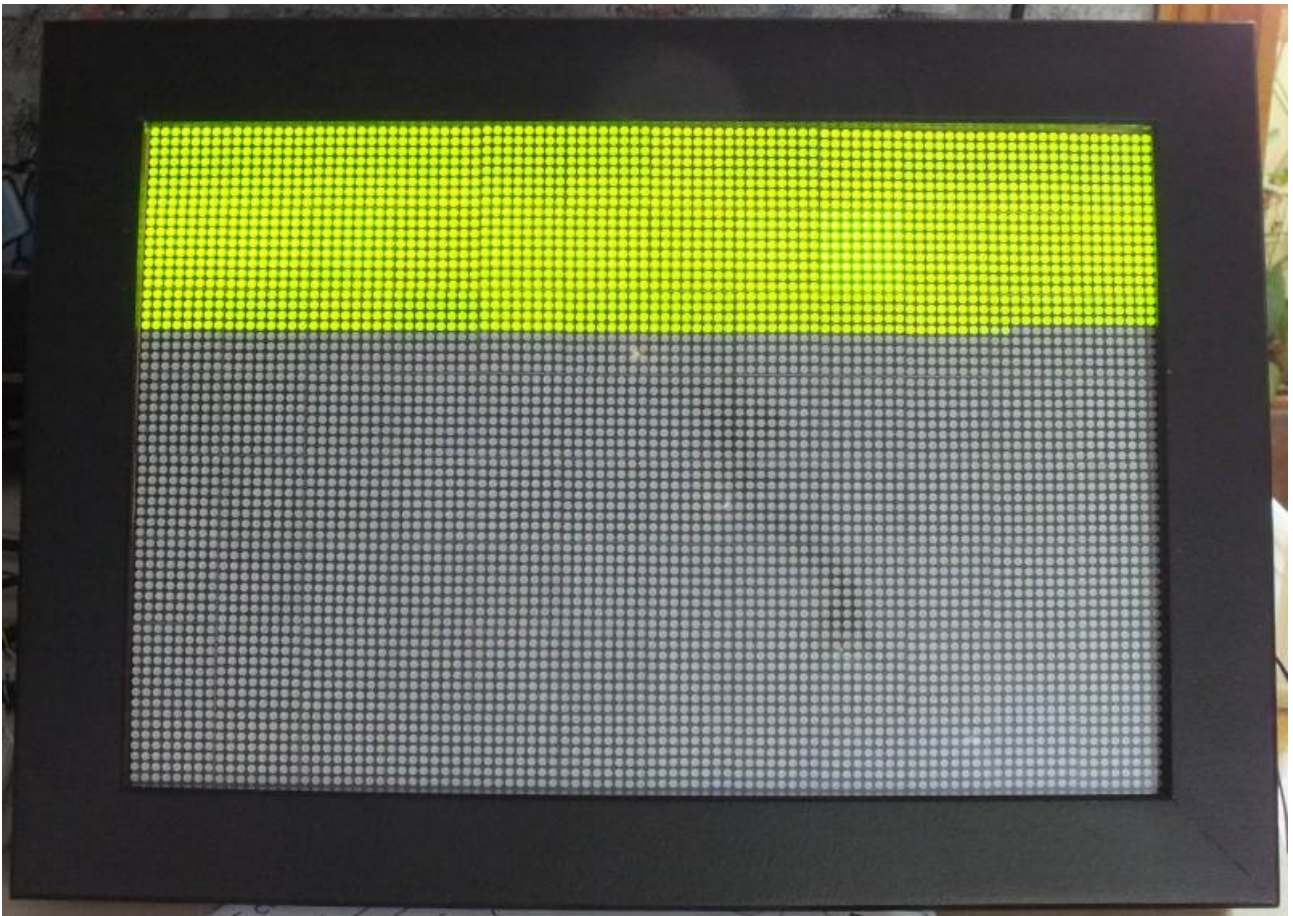
FIGURE 9.12 – Programme de base, rempli l'écran pixel par pixel
